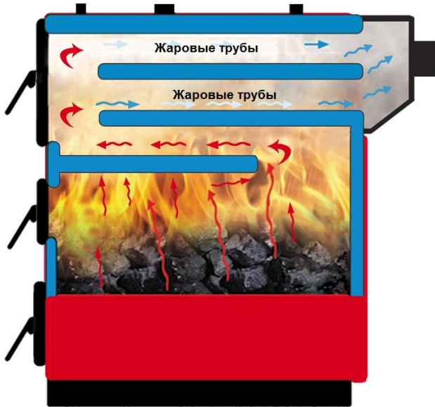
Малюнок 5 - Котел RK3G 20-100, схема руху димових газів.
