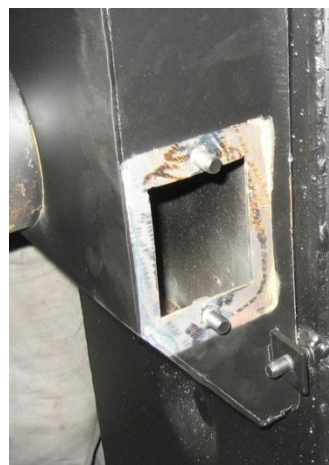
Рисунок 10 – Отверстие для чистки адаптера дыма
