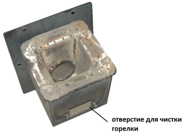
Рисунок 11 – Отверстие для чистки горелки.
