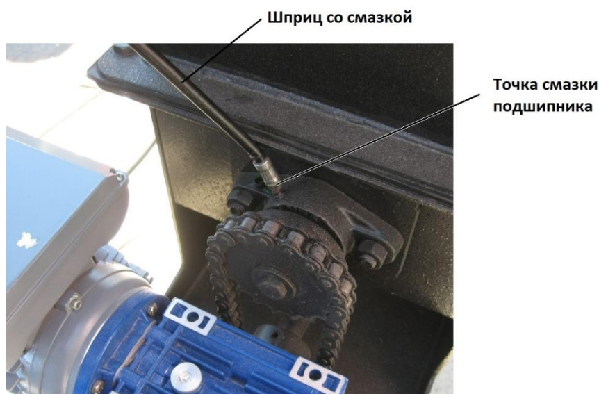
Рисунок 8 – Смазка подшипников шнековой подачи.
